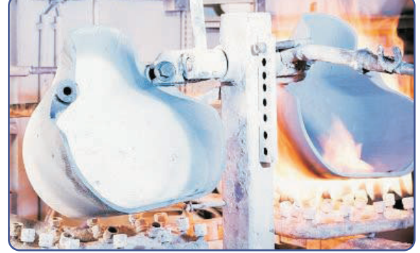
Ekamold® Cast C Alüminyum Billet Sektörü için Boron Nitrit Kaplayıcılar Ekamold® Cast C Boron Nitride Coatings For Aluminium Billet Production
