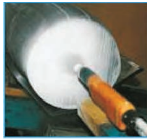
Biyetin Kaplanması Coating of the billet
