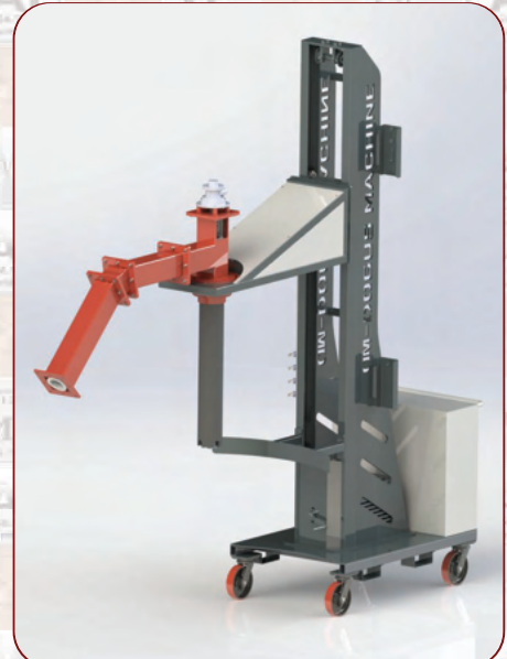
Fırından fırına, potadan potaya, fırından potaya ve fırından külçe kalıbına hızlı metal transferi
