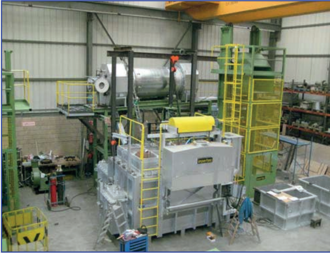
Talaş Ergitme Sistemi Ön Montajı
