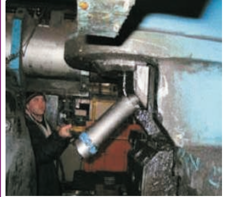
Kuru Yağlayıcı Ürün Dry lubricant for Aluminium extrusion
