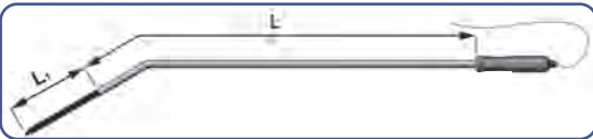
Daldırma El Probları 1XNiCrNi Tipi 1200 °C Immersion handheld Probe 1XNiCrNi Type 1200 °C
