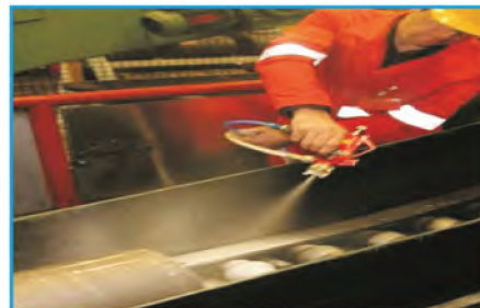
Biyetin Kaplanması Coating of the billet
