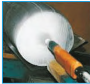
Biyetin Kaplanması Coating of the billet
