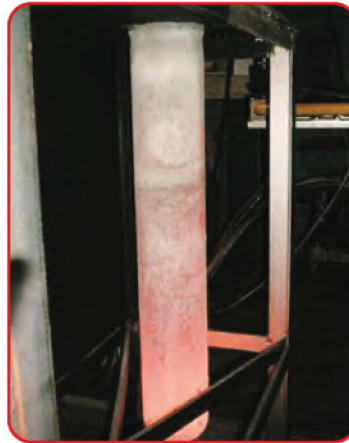
EKatherm® Isıtıcı Tüpler Yüksek klor ergitmede üç hafta sonra
