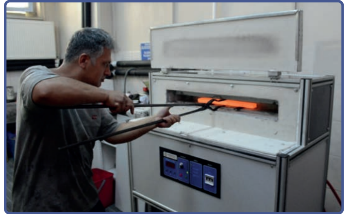
Lama Tavlama Ocakları Bar Annealing Furnaces
