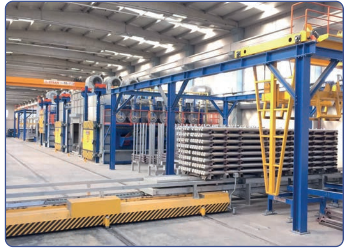
Otomatik Biyet İstifleyici & İstif Bozucu Sistem Automatic Billet Stacker & Destacker System
